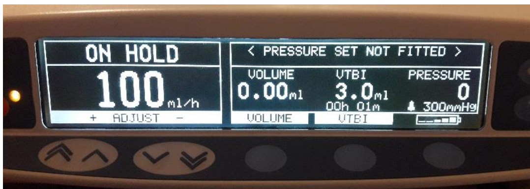
Slika 8.3. Infuzijska črpalka z brizgalko.
