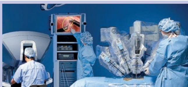
Slika 2: robotski sistem da Vinci® je najbolj uporaben kirurški robot po svetu, do začetka leta 2018 so jih po svetu namestili več kot 4500, kirurgi so z njim naredili več kot 5 milijonov robotsko asistiranih posegov.
